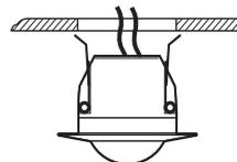
Realice el cableado según el Punto 5 e introduzca el sensor en el orificio realizado previamente.
